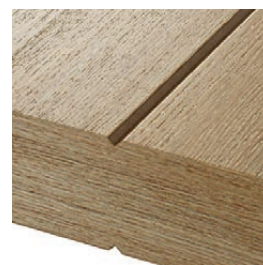
zbliżenie na frezowanie - widoczna struktura podłoża
